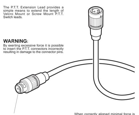
ROTATE THE OUTER LOCKING RING TO ALIGN THE KEY WAYS BEFORE INSERTING THE PLUG.
